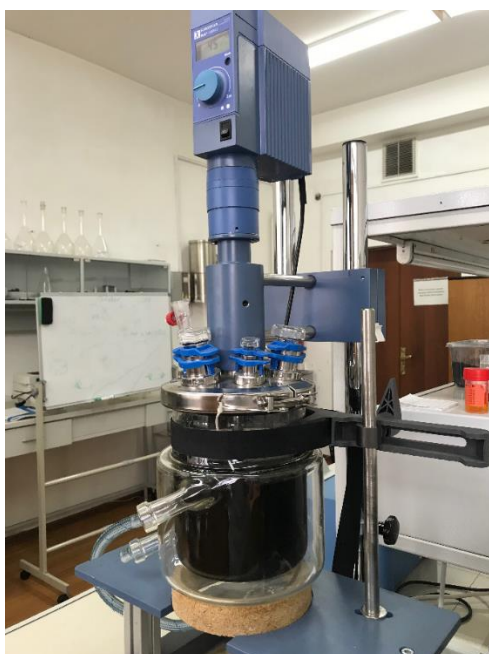
Сурет 36 – Қоңыр көмірді биоөңдеу бойынша тәжірибе жүргізуге арналған биореактор
