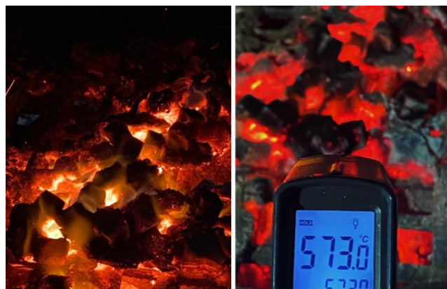
Сурет 43 – Қарапайым жылыту пештерінде жағу кезінде брикеттердің отын-энергетикалық тиімділігін анықтау
